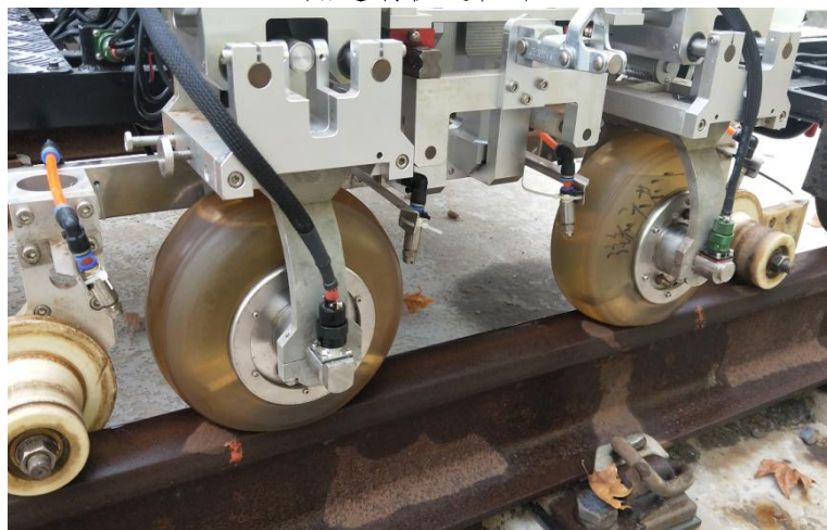
搭载于低速钢轨巡检车的超声检测部件
