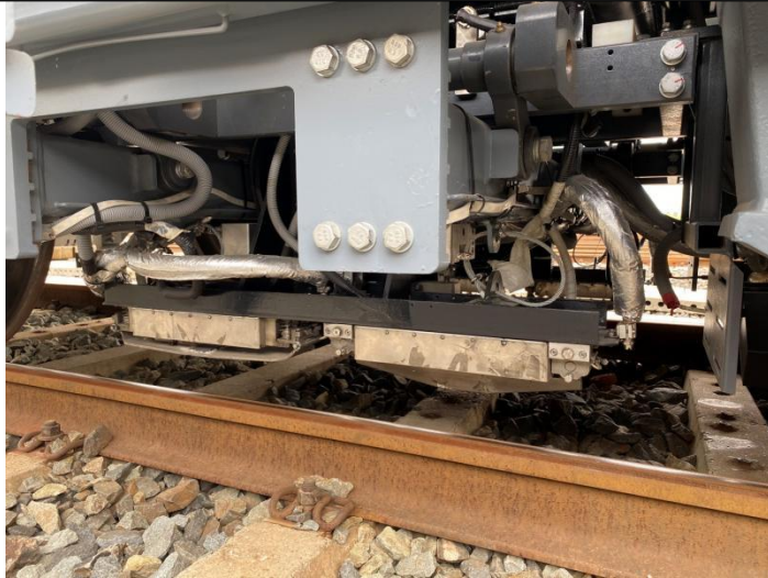
搭载于GTC-80的钢轨伤损漏磁检测系统
