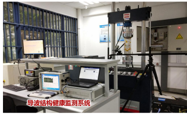
图1 飞机蒙皮铆钉孔疲劳裂纹损伤的在线扩展预测
